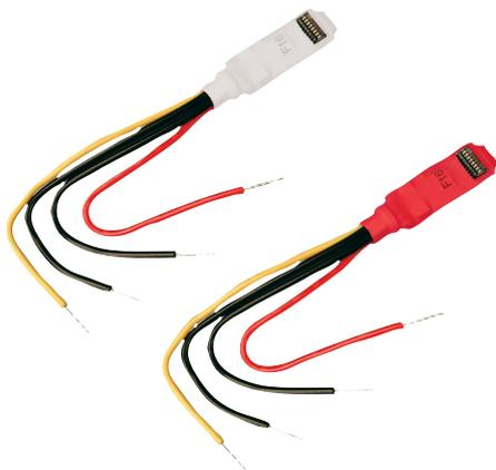
DS7457i 系列单防区输入模块包括 DS7457i 和 DS7457iF 两个型号。每个型号均具有用于连接常开 (NO) 或常闭 (NC) 触点的受监测输入防区。DS7457i 系列使用 47 kΩ 终端 (EOL) 电阻监测触点。每个型号均可与兼容的多路复用扩展模块配合使用，并且占用系统上的一个多路复用防区地址。DS7457i 设计用于防盗应用场合，而 DS7457iF 设计用于防火应用场合。
