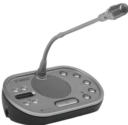
具有投票功能和通道选择器的讨论装置可以使与会人员发言、登记发言请求、听取他人发言以及投票。它提供了用于连接可插拔话筒 (DCN-MICS 和 DCN-MICL, 需要单独订购) 的插座。该装置具有五个适于所有投票类型的投票按钮。投票按钮周围的黄色指示环可用于提示用户登记出席、开始投票和确认投票。当该装置的出席 LED 指示灯呈黄色亮起时，表示代表出席会议。
