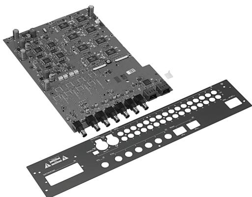
要将不含光纤网络连接的发射机 (LBB 4502 系列) 升级到具有光纤网络连接的发射机 (INT-TX 系列), 需要使用发射机升级套件 (INT-TXK)。升级套件包括发射机主 PCB 板、后面板、胶柱以及用于将主 PCB 板安装在 LBB 4502 发射机壳体内部的螺钉。
