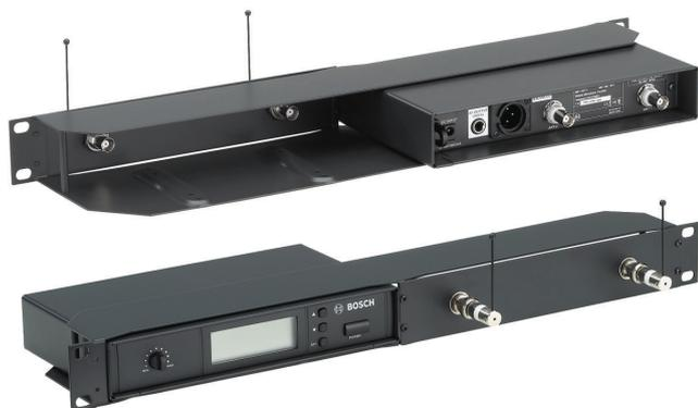
此套件用于将 MW1-RX-Fx 无线话筒接收器安装在 19 英寸机柜中。它可以两个接收器并排安装在一个单位高的机柜空间中。当只使用一个接收器时，另一半的机柜空间可用于安装附带的面板，该面板可以安装两个天线。它们通过 2 根附带的 BNC 电缆与接收器连接。
