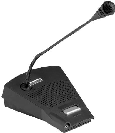
PRS-CSR 的功能与 LBB 4430/00 基本呼叫站相同，但它使用 CAT-5 电缆来连接 Praesideo 网络。它以一対一方式连接至 PRS-CSI 呼叫站接口，此接口是 Praesideo 光纤网络的组成部分。CAT-5 电缆用于传输数字音频和控制数据，最长可达 1 千米。CAT-5 电缆的长度不属于 Praesideo 光纤网络长度的一部分。因此，这大大增加了光纤网络的总长度。
